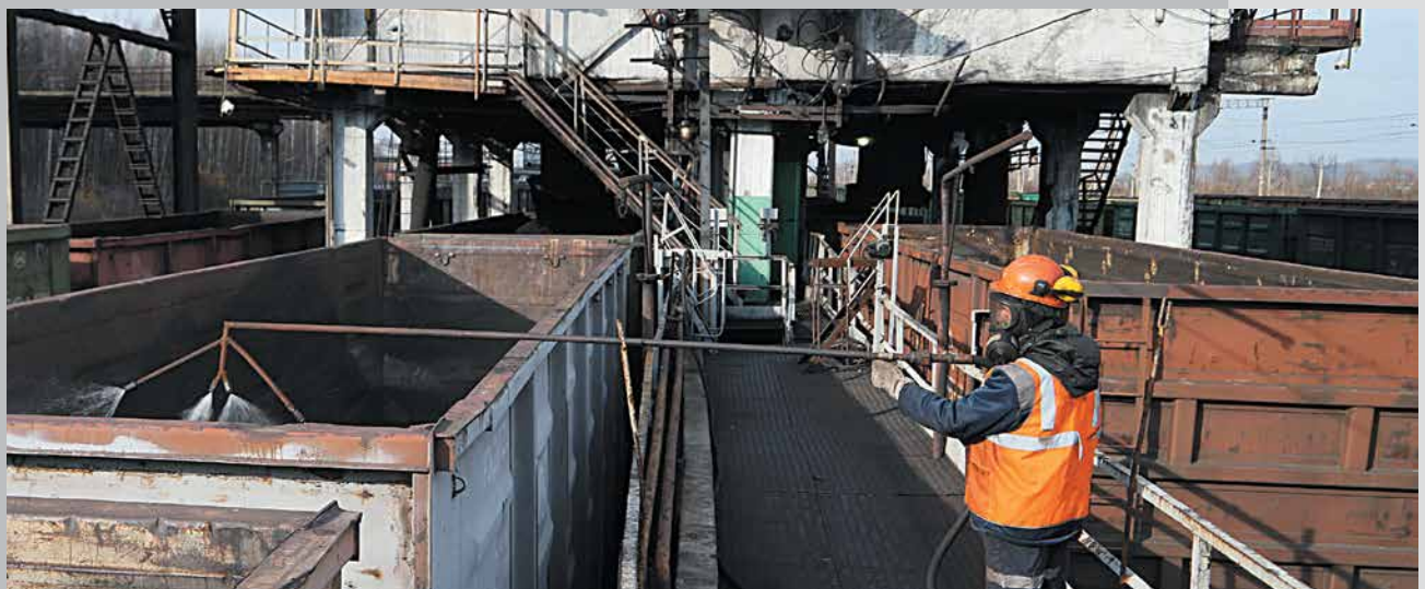
В путь-дорогу. Зимний план. Дмитрий Робкин, грузчик угля участка углеприема и погрузки ЦОФ «Сибирь» УК «Южный Кузбасс», обрабатывает вагоны специальным составом — профилактические меры против смерзаемости продукции
